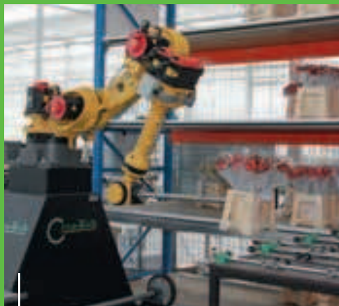
De gerobotiseerde 'magazijnbediende' geeft iedere emmer een plaats in de dagvoorraad en onthoudt deze. De robot kan ook gelijktijdig tot zes veilingkarren of denen laden volgens opgegeven specificaties.
