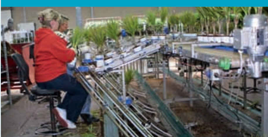
Na het schoonmaken glijdt de pot via een geleidingsbaan naar een lager gelegen band, die de pot door de camerasorteerder voert.
